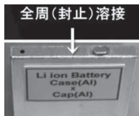
図7 レーザ溶接の電池ケースへの応用の例<sup>10)</sup>
